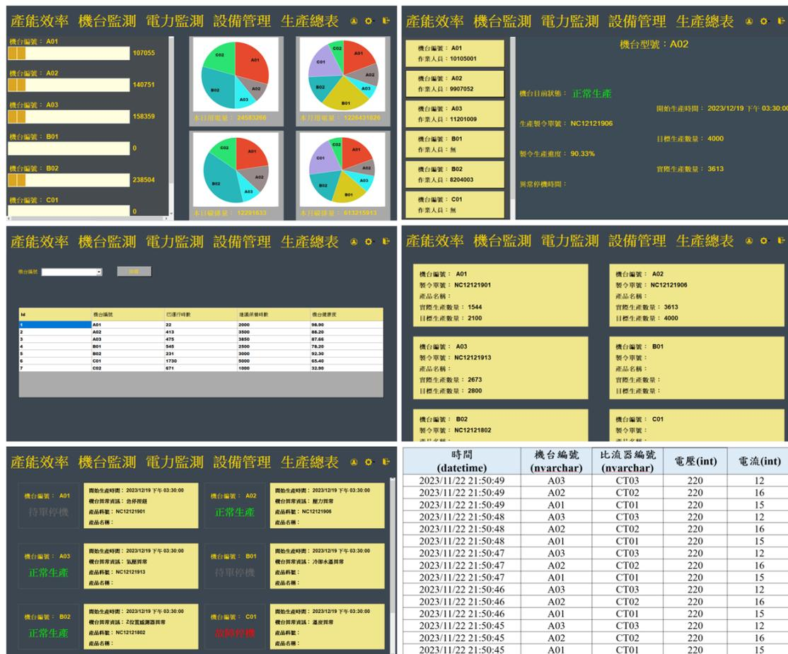
圖2 智慧工廠戰情室與線上異常預警系統實際介面
